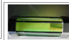
Czynnik chłodniczy z prawidłowo wymieszany olejem PAG.
