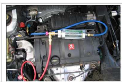
Przykłady diagnozowania układu klimatyzacyjnego. Pokazanie stanu czynnika chłodniczego na samochodzie.
