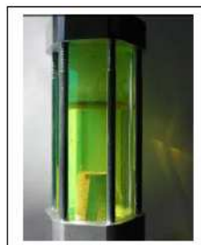
Powyżej: olej o niskich właściwościach mieszalnych W środku: barwnik UV Na dole: Czynnik chłodniczy zabarwiony barwnikiem UV
