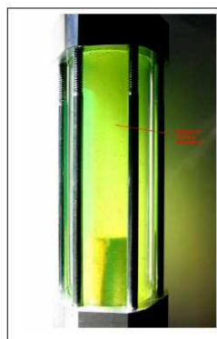
Przykłady diagnozowania układu klimatyzacyjnego. Pokazanie stanu czynnika chłodniczego na samochodzie.
