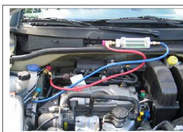
Przykłady diagnozowania układu klimatyzacyjnego. Pokazanie stanu czynnika chłodniczego na samochodzie.
