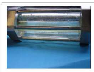
Czynnik chłodniczy z rozpuszczonym olejem i z cienką warstwą wody
