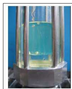
Poniżej: czynnik chłodniczy. Powyżej: Nierozpuszczony olej i krople wody
